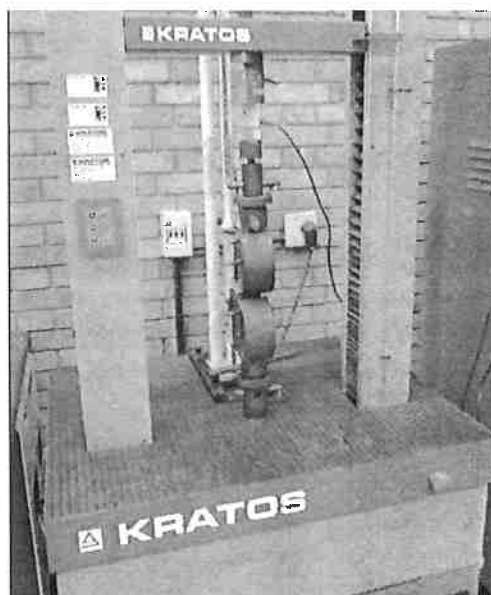
Fig. 9: Equipamento KRATOS utilizado nos ensaios de tração
