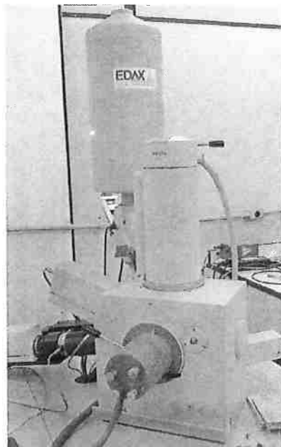
Fig 11. Microscópio eletrônico Philips EDAX XL30
